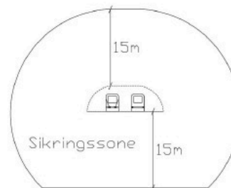
Teoretisk tverrsnitt Tunnel og sikringszone
