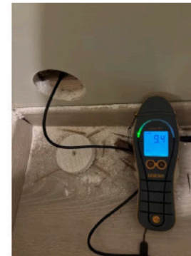
Hulltaking med fuktmåling fra tiliggende entre/gang mot våtsone, uten avvik.
