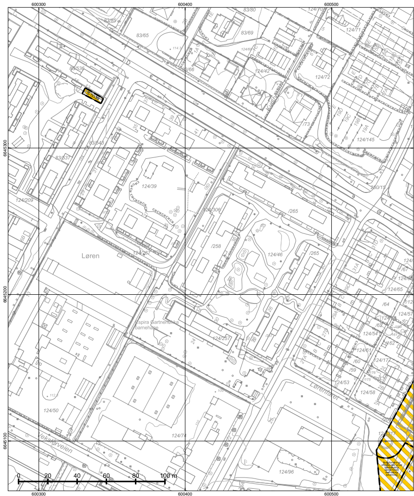
*regulert kotehøyde med Oslo lokal som høydereferanse. Ved prosjektering legges 37 cm til denne kotehøyden. © Plan- og bygningssetaten, Oslo kommune
