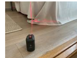
nivellering soverom, avvik ca. 15-30 mm
