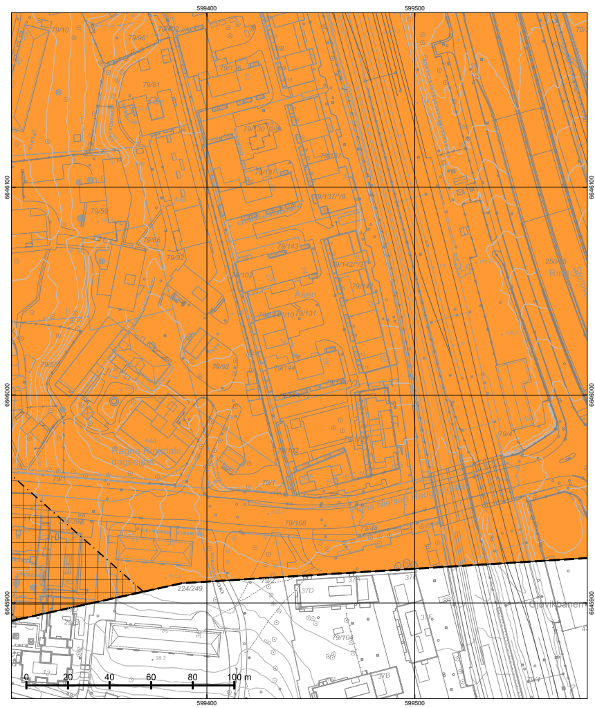
*regulert kotehøyde med Oslo lokal som høydereferanse. Ved prosjektering legges 37 cm til denne kotehøyden. © Plan- og bygningssetaten, Oslo kommune
