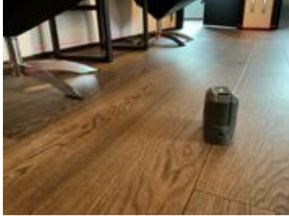
Nivellering trapperom + soverom, små avvik
