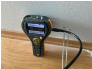
Fuktmåling med trepigg
