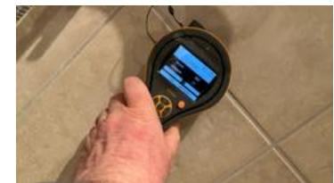
Fuktsøk ved badekar
