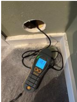
Hulltaking med fuktmåling mot våtsone uten avvik målt fra tiliggende entre/gang.
