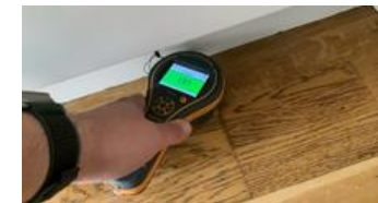
Ved bruk av fuktindikator registrerte jeg ingen forhøyede verdier.
