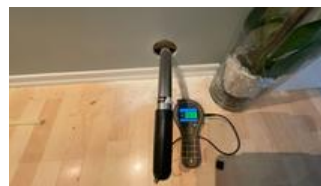
Fuktsøk fra tilstøtende rom
