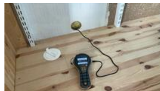
Ved fuktmåling er det ikke registrert måleverdi som indikerer fukt.
