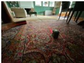
Nivellering kjellerstue, små avvik ca. 10 mm.
