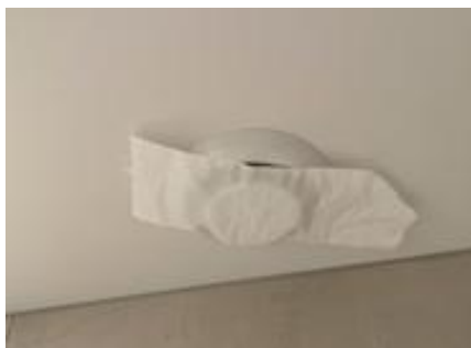
Avtrekksventil bestod papirtesten
